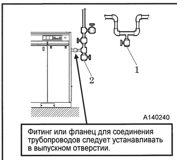
Фитинг или фланец для соединения трубопроводов следует устанавливать в выпускном отверстии.
