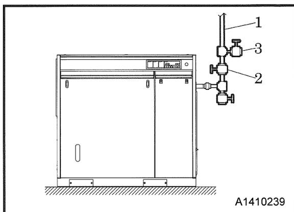
(1) Для проведения испытания, проверки или работ по техническому обслуживанию устанавливайте на главную выпускную трубу "1" запорный клапан "2". Для параллельной работы нескольких станций также необходимо устанавливать запорный клапан "3" на каждую станцию. Более того, рекомендуется устанавливать клапан на трубу в соответствии с тем, как показано на рисунке для присоединения запасной станции.
